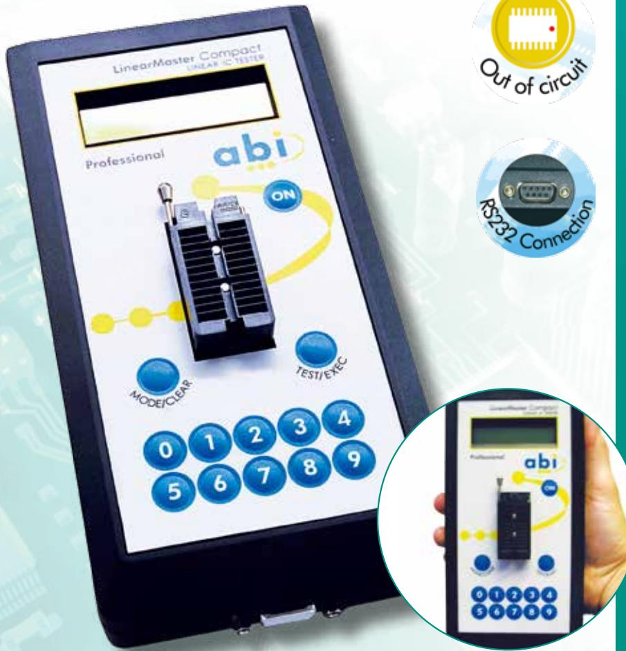
LinearMaster模拟集成电路测试仪几乎包含了所有常见的模拟IC器件，如：运算放大器，电压比较器，电压调节器，模拟开关、多路转换器、光耦、耦合器，音频电路等，元器件库可以根据需求自己编程扩充。
